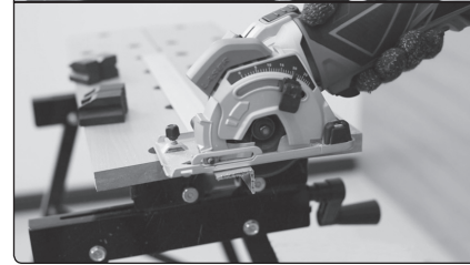
21. ábra. Alumínium profil fűrészrendése.
