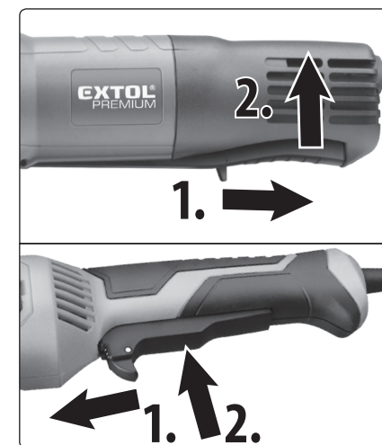
Abb.15; Schritt1. Entriegelung, Schritt 2. Einschaltung
