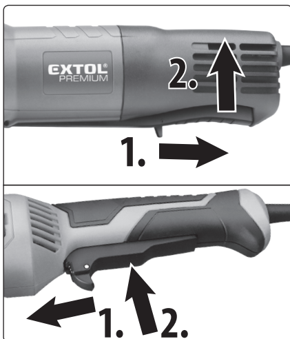
Obr. 15; krok 1. odistenie, krok 2. zapnutie
