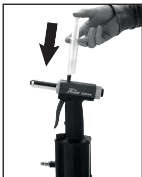
13. ábra. Olaj közvetlen adagolása a szegecselőbe.
