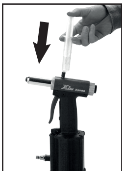
Obr. 13, vnášení oleje do nýtovačky stříkačkou
