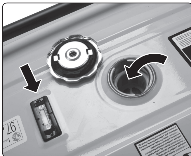
Obr. 13, ukazovateľ množstva paliva v nádrži a sitko v hrdle palivovej nádrže
